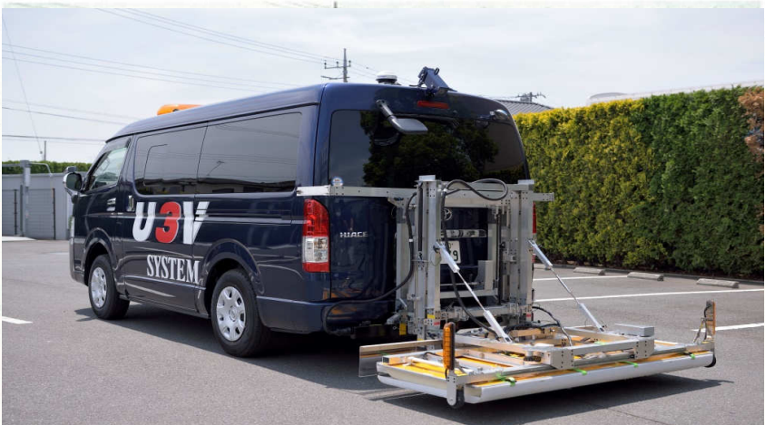
3Dレーダ探査システムU3V SYSTEMも、オリジナルの探査車。後部レーダを搭載し、高速で走行しながら路面下の空洞や亀裂、構造物の劣化などを探査できる。豊富なデータを同時に計測することができ、それを分析することで問題ある箇所を特定
